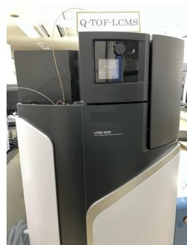
※四重極飛行時間型液体クロマトグラフ質量分析計
